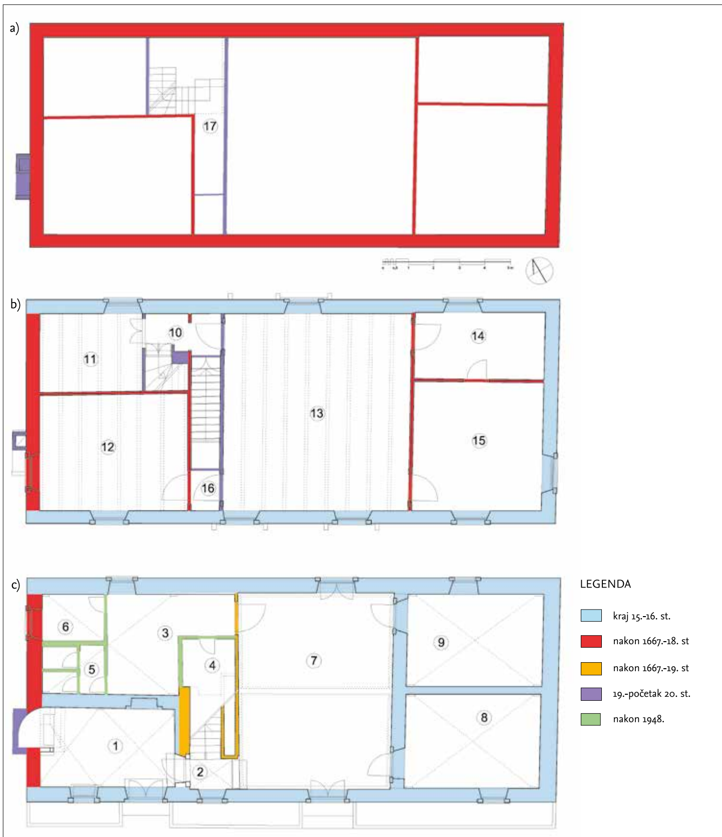
Grafički prikaz datacije zidova ladanjske kuće: a) tlocrt potkrovlja, b) tlocrt kata, c) tlocrt prizemlja
