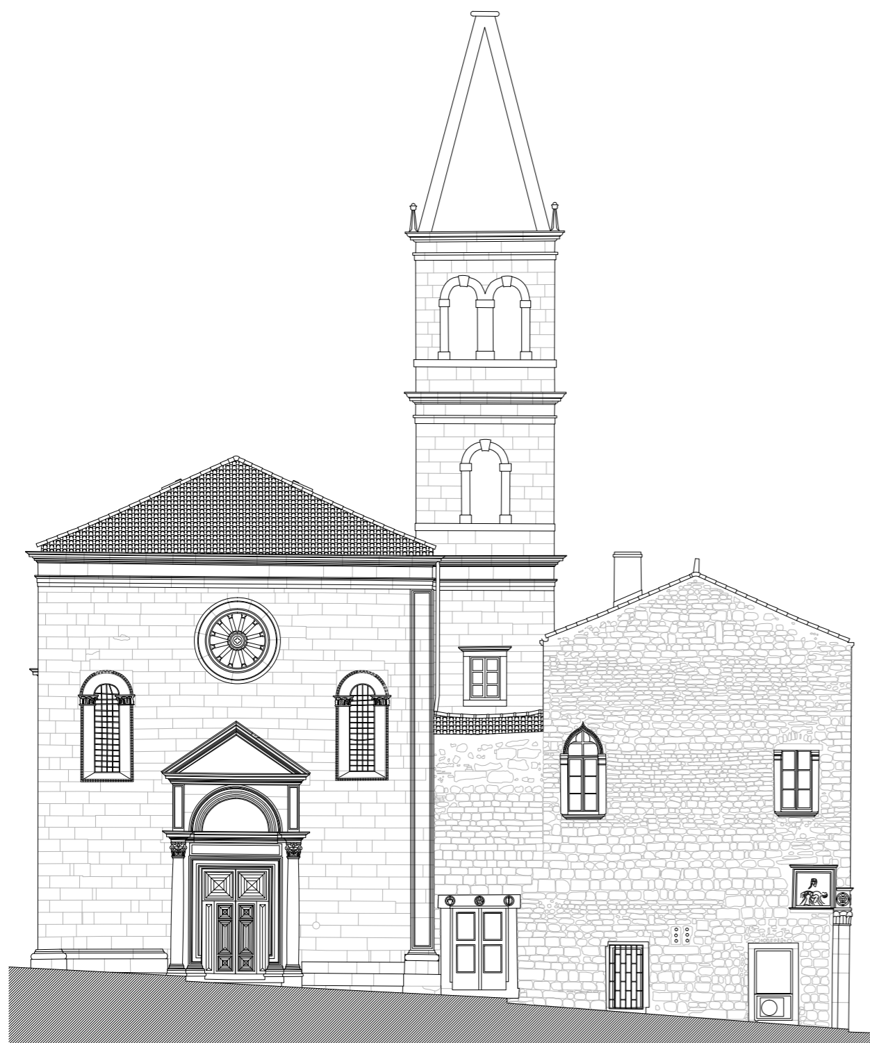
Šibenik, Nova crkva s dvoranom bratovštine. Arhitektonska snimka postojećeg stanja. Izrada: Skimi64, 2020.
