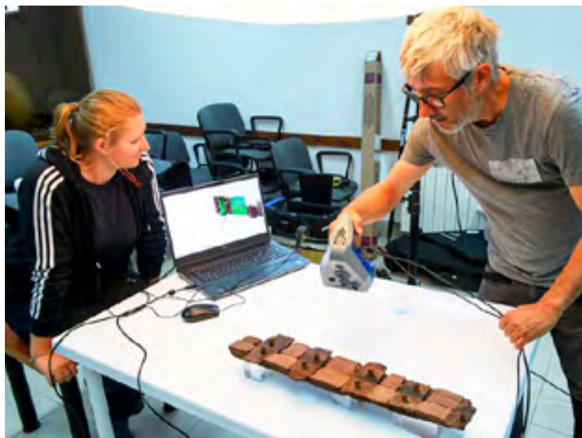
Otok Ilovik, uvala Paržine. Skeniranje dijela brodske konstrukcije. Snimka: P. Dugonjić, 2022.
