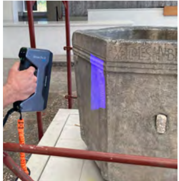
Split, Muzej hrvatskih arheoloških spomenika, Višeslavova krstionica. 3D lasersko snimanje krstionice. Snimka: M. Barišić, 2022.
